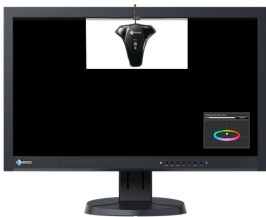
Aufzeichnung von Weißpunkt- und Helligkeitswerten bei der Kalibrierung mit einem externen Sensor
