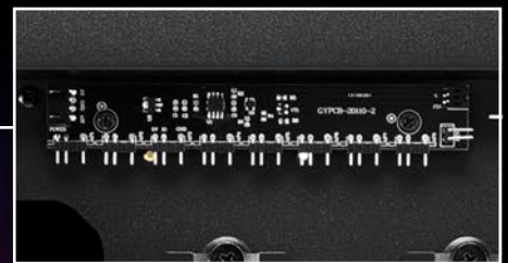
RGB-Steuerung für bis zu acht adressierbare LED-Elemente
